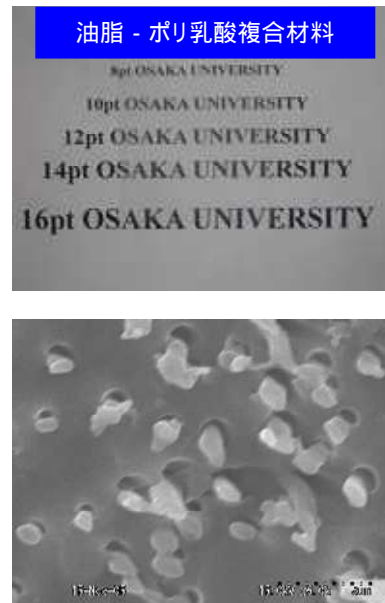
図5 植物油脂 - ポリ乳酸ナノファイバー複合材料：(上) 透明フィルム、(下) 断面SEM写真
