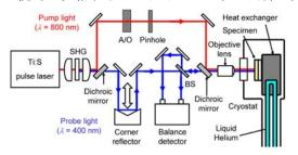
空断熱と輻射シールドによって優れた断熱性を持つ. 試料は熱交換器に固定されたサンプルホルダ上に真空用グリースで貼り付けて固定する. 熱交換器には温度センサとヒーターが取り付けられており, 室温から4K程度まで試料温度を調整することを可能とした.
