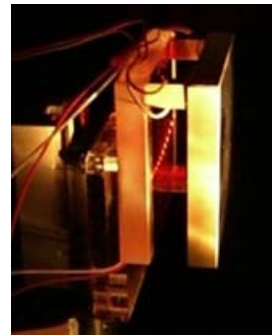
図1 多重反射による位相シフト機構
