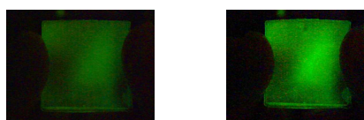
(a) 力適用なし (b) 力適用 図 8 応力発光材料の塗布
