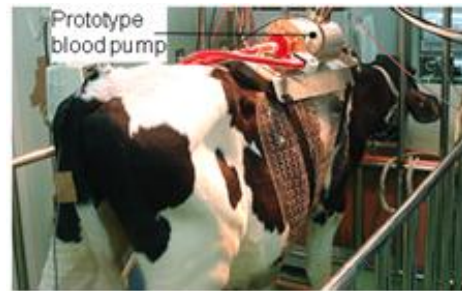
図12 雄牛に体外設置補助人工心臓を用いた試験の様子
