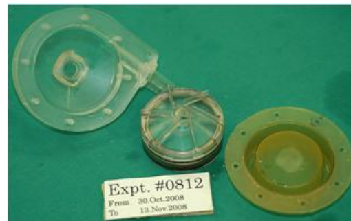
図13 使い捨てポンプヘッドないの動物試験後の状態(血栓確認されない)
