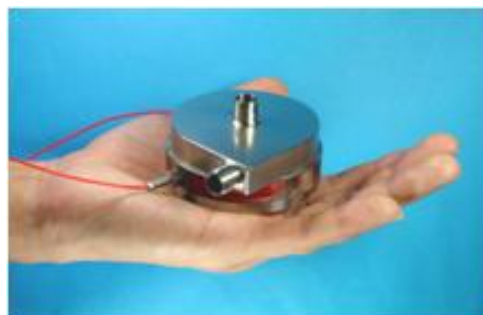
図8 チタンフレーム製磁気浮上血液ポンプ
