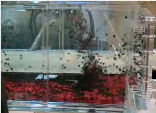
図5 下部水槽内の模擬ハイドロートの挙動
