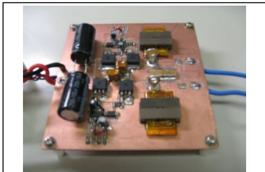
図7 試作薄平面形インバータの外観
