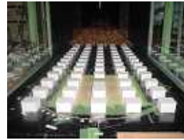
図3 風洞実験の状況(隣棟間隔2Hb)
