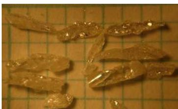
図 3.  $\text{BaTi}_2\text{O}_5$  単結晶。
