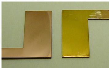
図8 接触法によるCu板表面の黄銅化(左:合金化前、右:合金化後)
