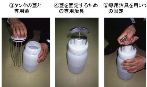
図6 着脱式給水タンクの使用手順(3)
