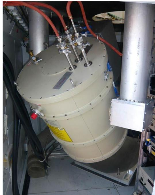
図 2. ASTE 望遠鏡に搭載された AzTEC クライオスタット。液体ヘリウムおよび液体窒素の注入口が上部に、クライオスタットの下側にアルミの楕円鏡が見える。
