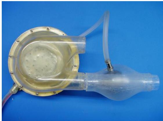
図 2 拍動型補助人工心臓に装着したコンプライアンスチャンバー一体型 in flow カニューラー
