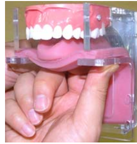
図5 舌が軟らかいゲル素材で出来た舌可動式声道模型
