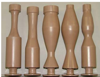
図1 肉厚一定の声道模型
