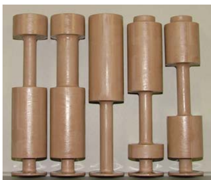
図2 円筒管接続式声道模型
