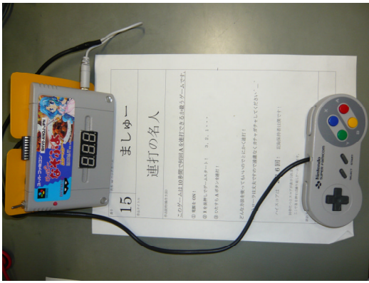
図 2 第 1 位となった「連打の名人」。定められた時間内に何回キーが押せるかというゲーム。本物のゲーム機のケースを改造して中にマイコン回路を実装している。
