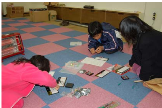
写真 2 回路図を見ながらブレッドボード上でLED点滅回路の製作に挑む小学生
