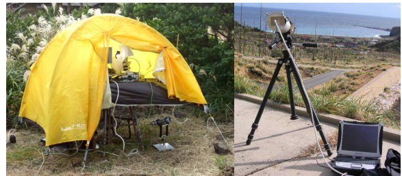
図5 DOAS光源装置とMAX-DOAS受光装置(左)、DOAS受光装置(右)
