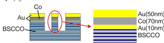
図 1 試料断面の概略図
