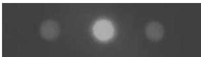
図 3 緑色レーザーの干渉縞で形成した回折格子を通過した He-Ne レーザ光の回折像。
