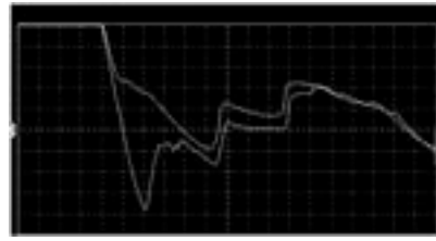
図3 BSA-ポリマー間の高温でのフォースカーブ測定（縦軸目盛は5 nm/div）
