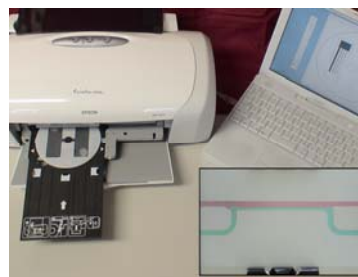
(図1) マイクロ化学チップを作製するためのインクジェットプリンター
