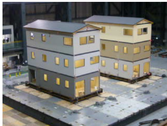
図10 実物大家屋の加振動倒壊実験
