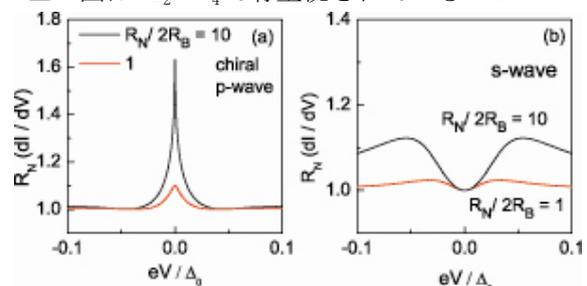
重項カイラルp波超伝導を仮定した結果であり、右の図は通常金属で発現するスピン1重項s波超伝導を考慮した結果である。スピン3重項超伝導体の接合ではゼロバイアス近傍
