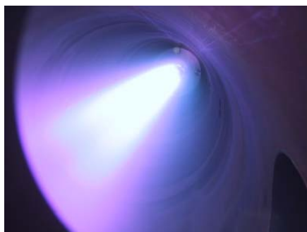
図 3. LHPD 内に生成された高密度アルゴンプラズマ。
