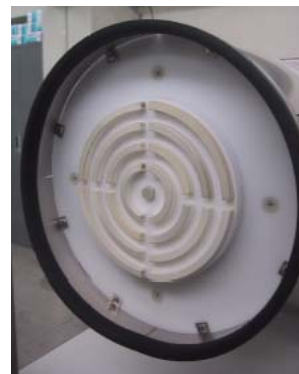
図 2. THD で使われている分割型多ループアンテナの写真。
