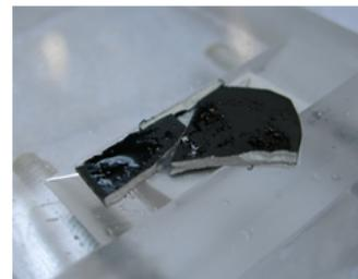
図 14 レーザー誘起水中衝撃波によって破砕された炭酸カルシウム試験片.
