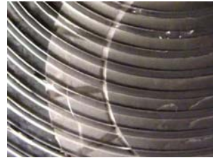
図7 螺旋溝工具での砥粒流れ
