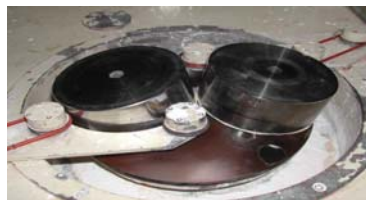
図 12 修正輪型加工の様子
