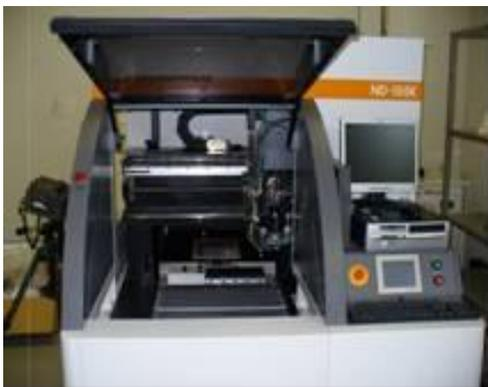
図 2 超高速スピンドル搭載の工作機械
