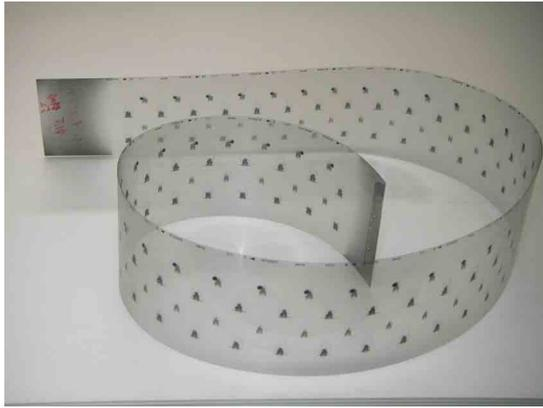
図 14 製作した 158 眼カメラによってフィルム上に撮影された 158 個の火炎像
