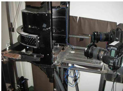
図 11 多眼カメラによる多時刻多方向同時撮影装置に加えられたトレーサー粒子軌跡のステレオ撮影装置
