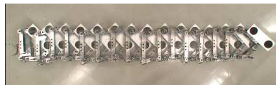
図4 平面5節リンク移動機構の直線経路追従動作
