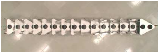
図2 3 叉移動機構の直線経路追従動作
