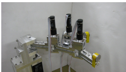
図 3(a) 構造可変型多肢ロボットアーム
