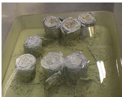
写真3 OPC(70%)+FA(30%) ( \text{pH}=0.5 希硫酸中)
