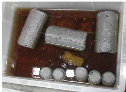
写真6 三成分系コンクリートの劣化状況
