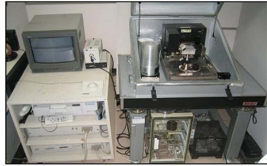
写真1 AFM(原子間力顕微鏡)
