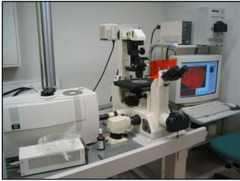
写真2 CLSM (共焦点レーザー顕微鏡)
