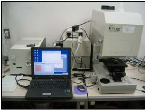
写真3 フーリエ変換型顕微分光装置
