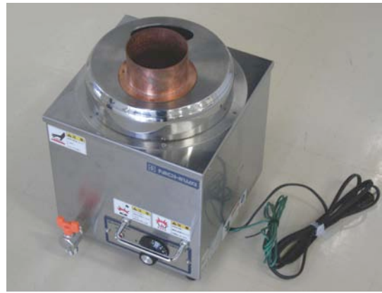
図9 インセットウォーマーを用いて復刻した膠鍋
