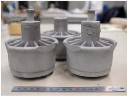
図 12 セラミック型により製作した鋳物
