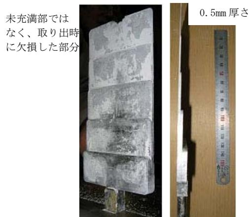
図11 試作2号機による試験片の例
