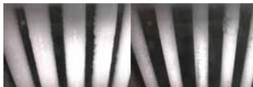
図6 ジェット噴射による霜層の吹き飛び
