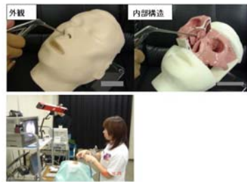
図 3 : 精密ヒト鼻腔モデルの外観と内部構造 そのモデルを使用した実験風景
