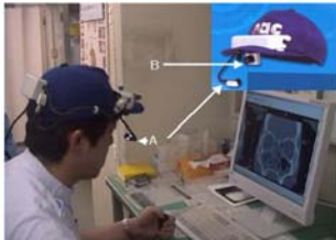
図 1 : アイマークレコーダによる視線追跡 A: 瞳孔撮影用 CCD カメラ、B: 視線上画像撮影用 CCD カメラ
