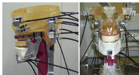
図2: ロボットの外観およびX線透視装置に位置付けた状態
