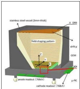
図 1 本研究の為に製作した三次元飛跡 検出装置「マイクロ TPC」。各辺が 30cm の立方体の内部が暗黒物質に対するター ゲットとなるガスで満たされている。
