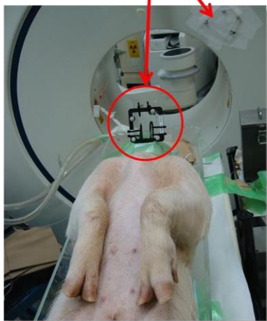
図 2 光学式三次元位置測定装置を用いての、マルチモダリティ画像重ね合わせのための位置測定
