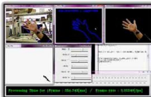
モーションキャプチャグローブを装着した状態で数例の外科手術を実施し撮影した。術具を並べてあるトレイの撮影も行った。手術室の照明を変えたり、数種のマーキングパターンやマーキングカラーのグローブを用意して撮影した。また、画像処理解析プログラムを作成した。プログラムでは、取得画像のエッジ検出、2値化、膨張収縮（欠損部の補間）、雑音除去（手袋のシワなどの除去）、ラベリング（各部の番号付け）、輪郭抽出（塗りつぶしのため）、塗りつぶし（特徴量算出のため）、特徴量算出（向き、長さ、位置な
