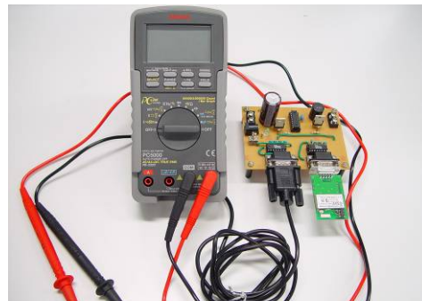
図8 計測器と連携したデータ収集ユニット
