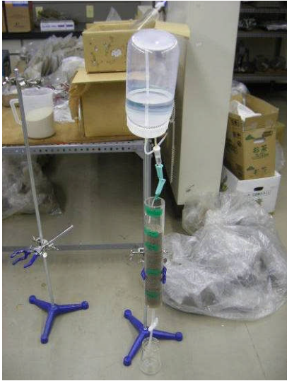
図9 浸透試験装置と試験のようす
