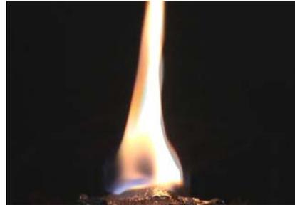
図3 高温低酸素同軸気流プール火災写真
