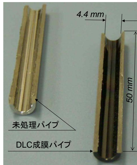
図6 1/4 インチステンレス鋼製パイプ内面への DLC 成膜.
