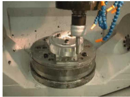
図 1: 円錐台加工試験の様子(本研究における加工試験例)
