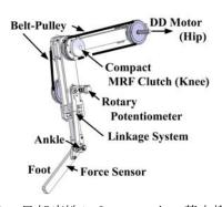
図5. 足部痙性シミュレータの基本構造
