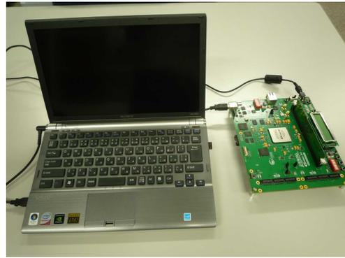
図3. FPGA ボードを利用した実験環境
