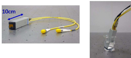
図 4 光ファイバ結合型分光チップの模式図(上)と写真(下)。
