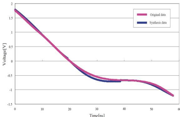
図12 3つのvan der Pol発振器を用いたカオス時系列データの予測結果。
