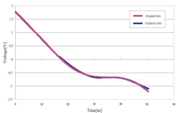
図13 4つのvan der Pol発振器を用いたカオス時系列データの予測結果。
