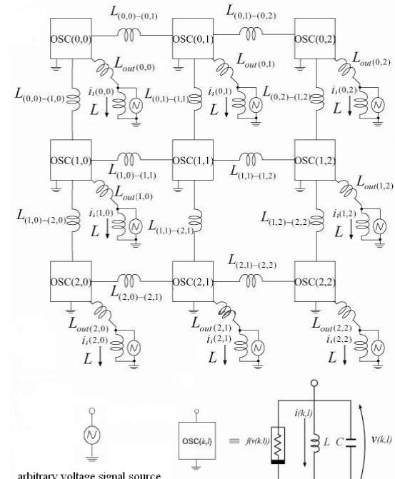
図 1 正規化した方程式を利用時の van der Pol 発振器を  $3 \times 3$  の格子状に結合したシステム。
