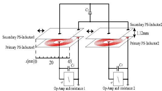
図 8 プリンテッド・スピライル・インダクタを用いた結合。
