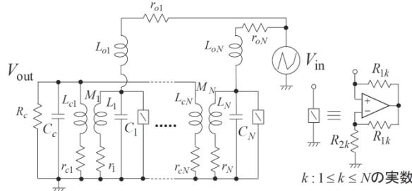
図 7 複数の van der Pol 発振器と共振器 1 つを結合したシステム。
