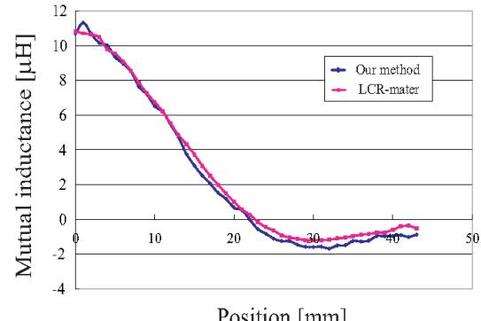
図 9 2 枚のプリンテッド・スピライル・インダクタの相対的な位置による相互インダクタンスの変化。
