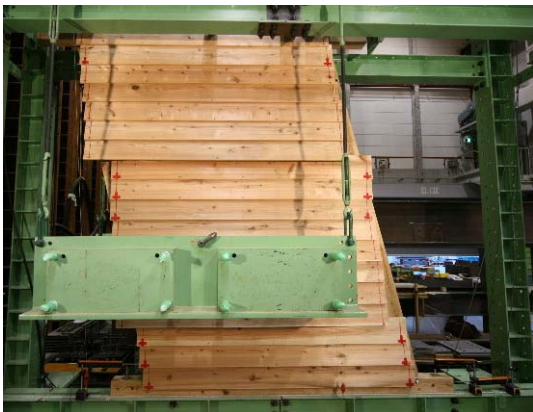
図 12 層間変形角 1/5\text{rad} の下見板試験体
