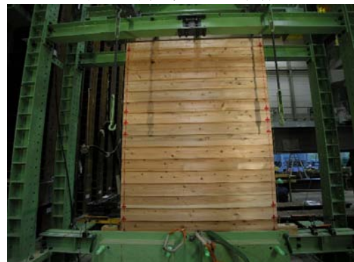
図4 下見板試験体写真
