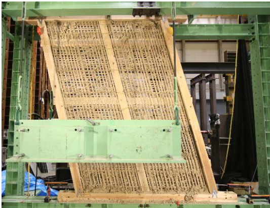
図 11 層間変形角 1/5\text{rad} の土壁試験体
